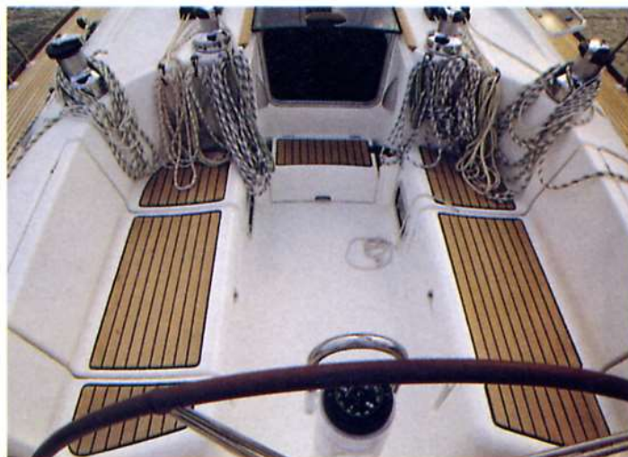
Nella versione crociera le manovre di scotta e di drizza sono concentrate sulla tuga, servite da quattro winch self tailing e due batterie di stopper: una soluzione che privilegia l'abitabilità del pozzetto (lungo 2,85m) ma penalizza la possibilità di interventi da parte del timoniere.
