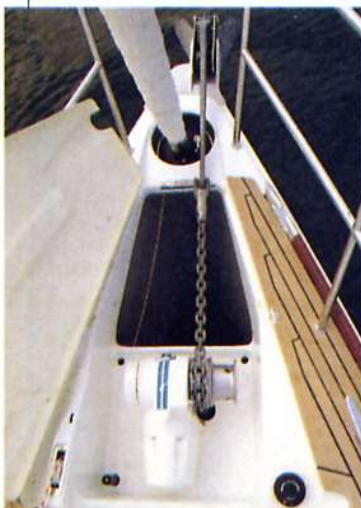
Estrema pulizia della prua, con il salpancore elettrico e il tamburo dell'avvolgifiocco montati sottocoperta.
